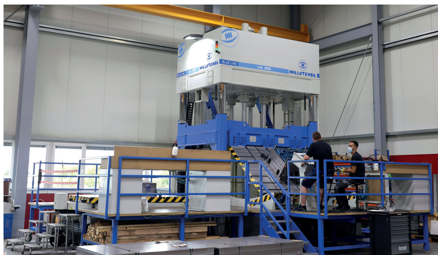
Die Millutensil MIL 253 Blue Line ist eine sehr kompakte Tuschierpresse, die den verfügbaren Platz gut ausnutzt. Ihre Bauhöhe lässt zur Hallendecke viel Platz – etwa für den Hallenkran © Millutensil/Wisa
